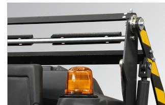
Système DSA : dispositif de vidange pour la vidange du réservoir dans des bacs à poussière jusqu'à 145 cm de hauteur.
